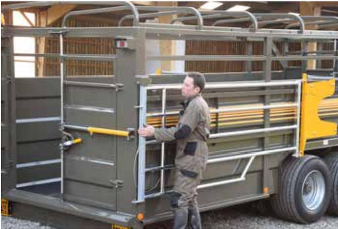
Modèles 5 lisses extensibles fabriqués en tubes de Ø 42,4 mm galvanisés à chaud, avec ou sans découpe pour passage de roue (voir tableau ci-dessous).
