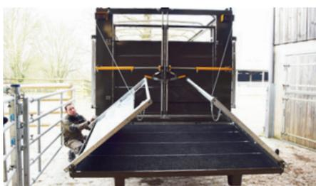
Pour l'utilisation des bétailières MERCURE avec des déchargements à quai, ou des utilisations sans barrière extérieure latérale, il est indispensable d'équiper le pont arrière de chargement de panneaux tôle servant à la canalisation des bovins.
